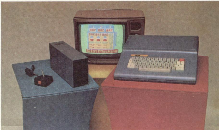
O teclado do Color 64 possui 53 teclas no padrão ASC II, sendo 44 de caracteres (cor cinza), oito de controle (cor branca) e uma de interrupção (vermelha).
